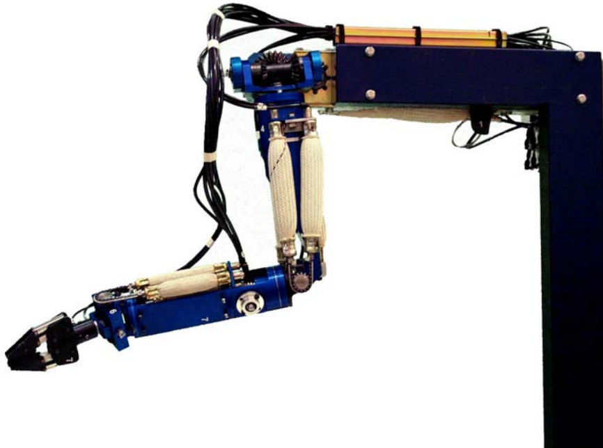
FIG. 2.12 – Vue de face du bras anthropomorphe 7 axes
