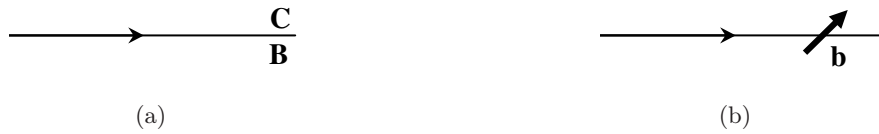
FIG. 28. Une dislocation et son vecteur de Burgers (a) en notation compacte (référéncée par rapport au tétraèdre de Thompson de la figure 24(b), page 43) et (b) non compacte.
