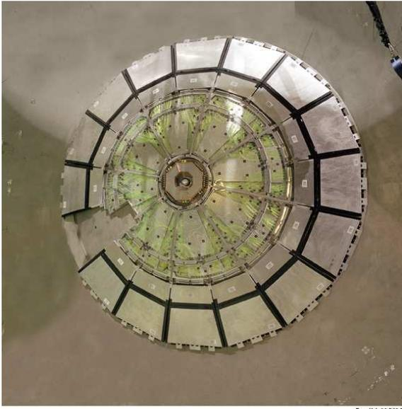
FIG. 2.2.10 – Vue du détecteur de pieds de gerbes monté sur la paroi du cryostat du bouchon du calorimètre électromagnétique avant fermeture du détecteur
