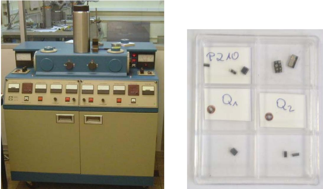
Figure 18 : Amincisseur ionique Gatan 600 utilisé au Laboratoire de Cristallographie et exemple d'un échantillon à différentes étapes de préparation des lames minces.
