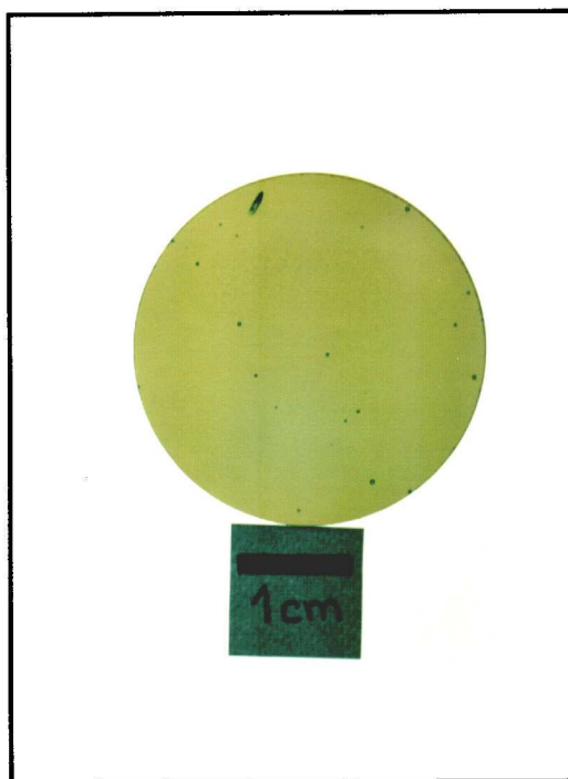
Photographie 6-1: Verre de stabilisation à 70% de cendres utilisé pour les expériences de lixiviation en mode statique sur monolithe.
