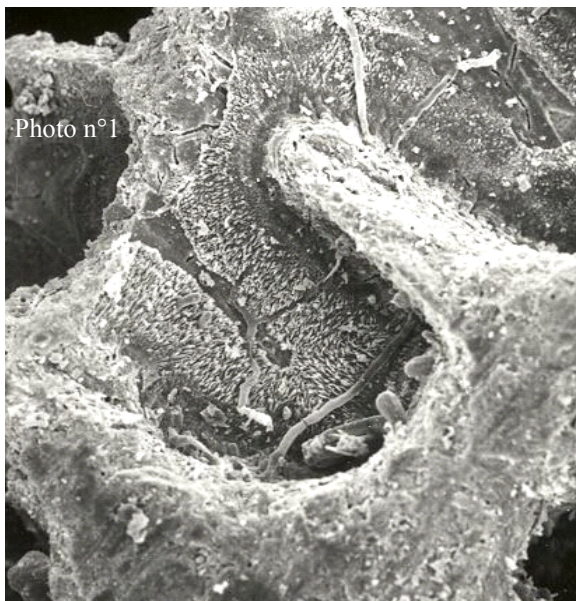
Planche Photographique n°4 : Observations MEB des zones cimentées dans les cavités du squelette corallien et présence de calcite magnésienne (Photo. 2).
