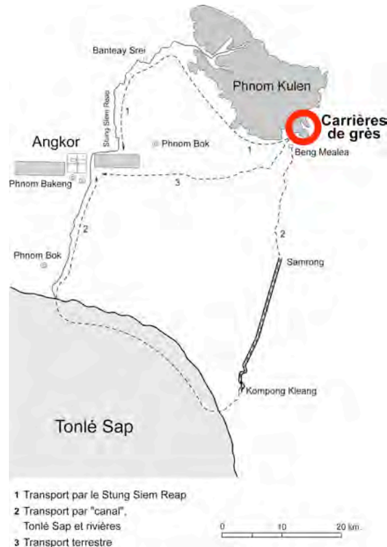
Fig. 151 : Localisation des carrières de grès au pied du Phnom Kulen et hypothèses des voies d'acheminement vers Angkor (d'après J. Laur)
