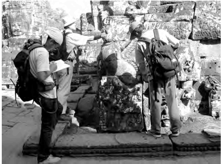
Ph. 802 : Prise de mesures de la susceptibilité magnétique du grès à la tour BY.49 par l'équipe du professeur E. Uchida
