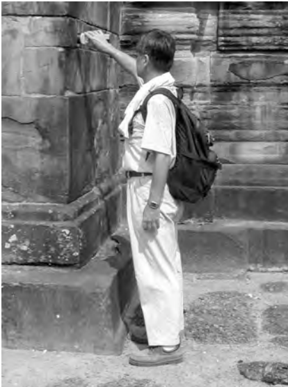
Ph. 801 : Exemple de prise de mesures de la susceptibilité magnétique du grès par le professeur E. Uchida
