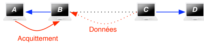
FIG. 1.40 – Scénario dans lequel l'utilisation de l' EIFS empêche des collisions entre acquittements et données en B
