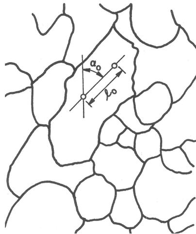
Figure I.19. Repérage de la déformation intragranulaire dans le modèle de Valiev – Langdon [Valiev '93].
