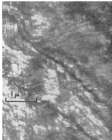
Figure I.28. Macles de déformation apparues après formation des cellules de dislocations pendant le choc [Nolder '64].
