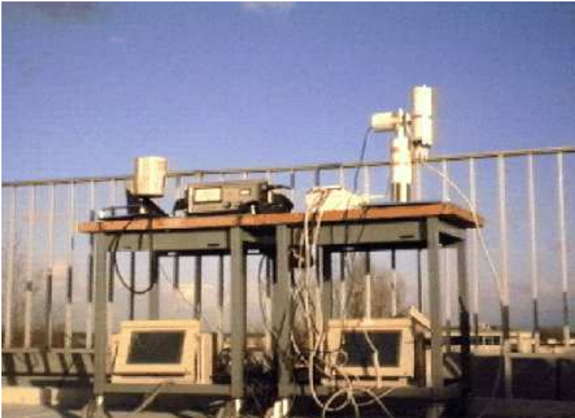
Figure 4.1: Le prototype CLIMAT et le radiomètre Barnes PRT-5 sur le toit du Laboratoire.
