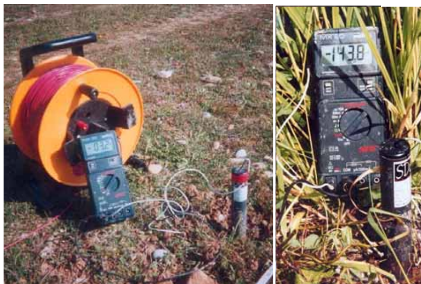
FIG. 1.10 – Electrode de mesure placée dans un trou avec une boue salée de bentonite. L'électrode est connectée à la borne positive du voltmètre, alors que l'électrode servant de référence est connectée à la borne négative.
