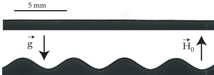
FIG. 4.10 – Instabilité de pic à la surface du ferrofluide dans une cuve de Hele-Shaw constituée de deux plaques distante de 1 mm. **En haut**, le champ est nul. **En bas**, le champ est perpendiculaire à l'interface ferrofluide gaz et vaut  $H = 17 \text{ kA/m}$ .
