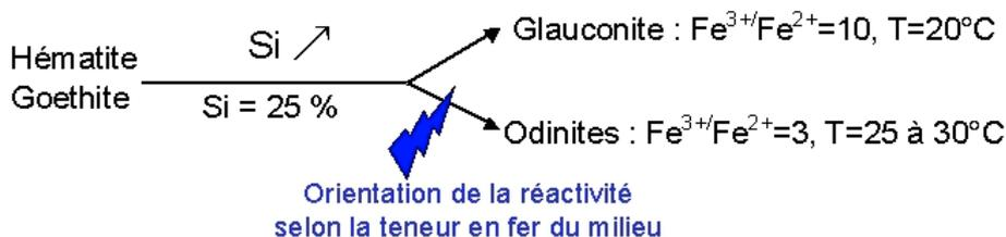
Figure 10 : Evolution des oxydes de fer en condition oxydante en fonction de la teneur en Si et Fe, d'après [Fernandez, 1998 #21 et (Porrenga, D. H. 1967)
