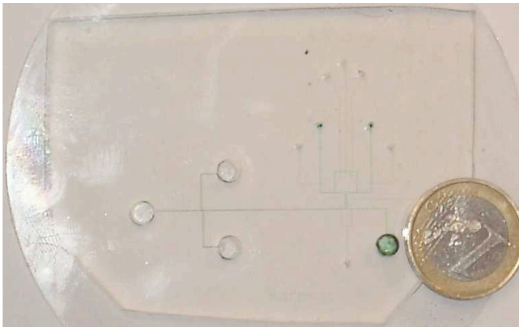
FIG. 2.2 – Photographie du microsystème. Les canaux fluidiques sont remplis d'un colorant vert. L'épaisseur typique des canaux est de 20 microns pour une largeur de 100 microns.
