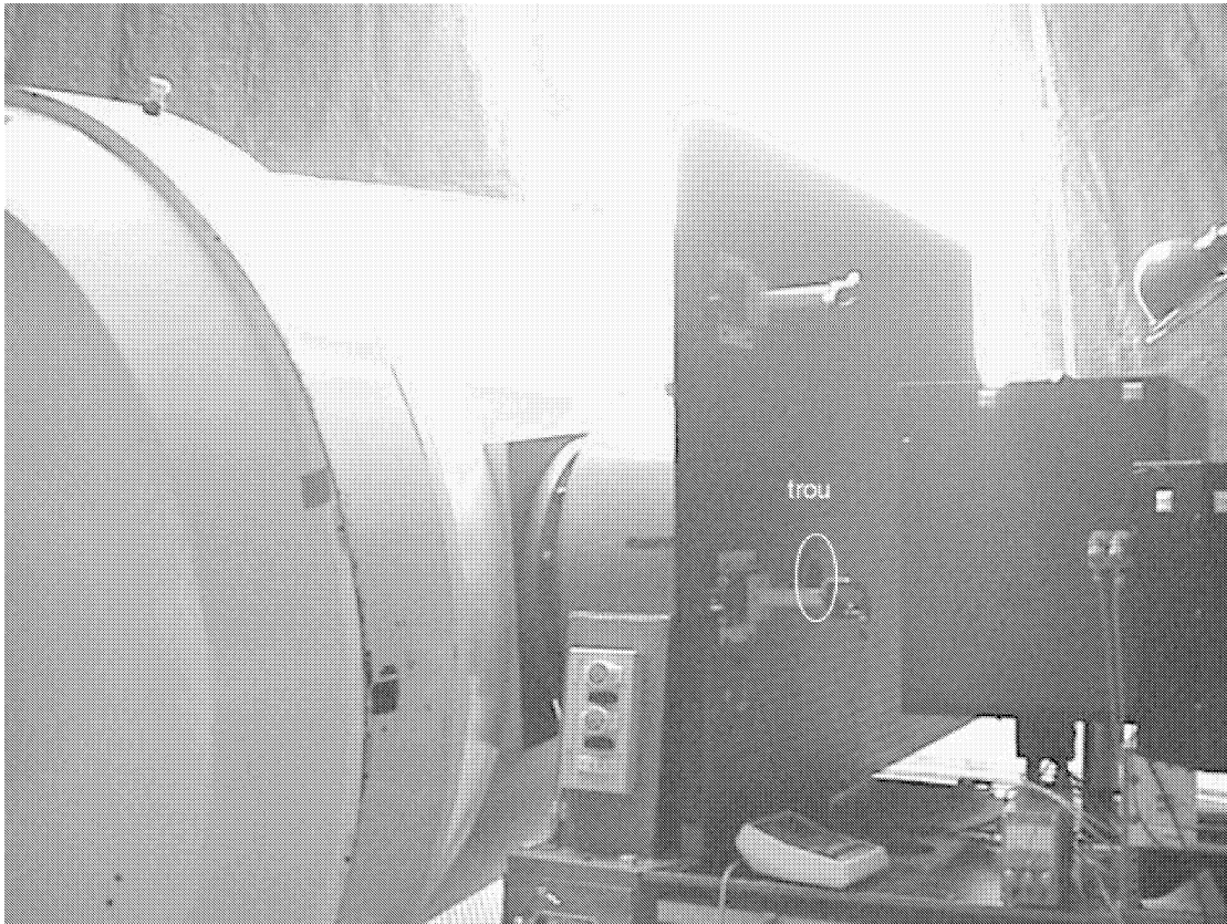
FIG. 9.2 – Le banc optique (ici avec seulement quelques éléments) est accroché verticalement devant le foyer Nasmyth. Un trou dans le banc permet au faisceau de le traverser pour être ensuite repris sur le banc. Sur la droite nous voyons le module de détection du laser utilisé en télémétrie.
