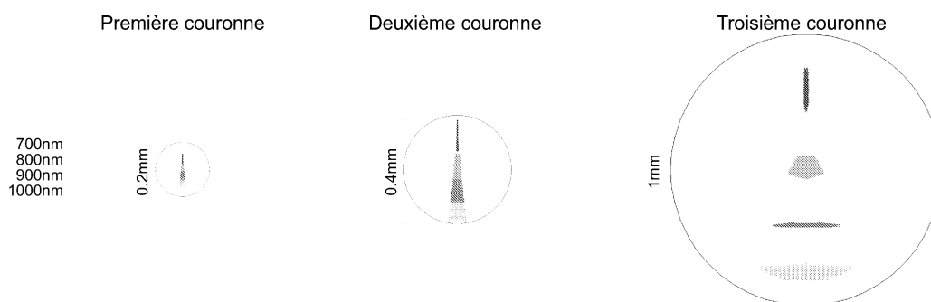
FIG. 3.5 – De gauche à droite, dispersion au foyer des sous-pupilles pour la première couronne, la deuxième et la couronne externe. La bande spectrale va de 700 à 1000nm.
