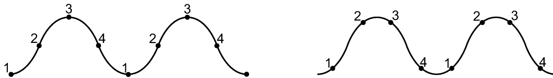
FIG. 4.2 – Deux configurations des 4 points d'acquisition durant le cycle d'oscillation de la membrane
