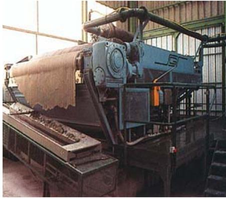
Figure I.6. Déshydratation par filtre presse
