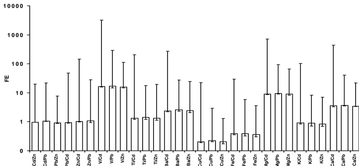
Figure n° III-9 : Facteur d'enrichissement des particules atmosphériques, PM<sub>10</sub>, par rapport au filtre prélevé dans la cheminée. Les barres d'erreur représentent les extréma et le sommet des histogrammes la médiane.
