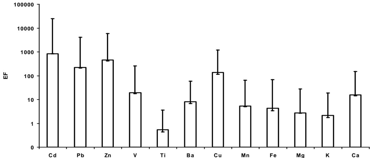
Figure n°III- 7: Facteur d'enrichissement des particules atmosphériques, PM<sub>10</sub>, par rapport à la croûte terrestre (Al). Les extrémités des barres correspondent aux extréma et le sommet des histogrammes à la médiane.
