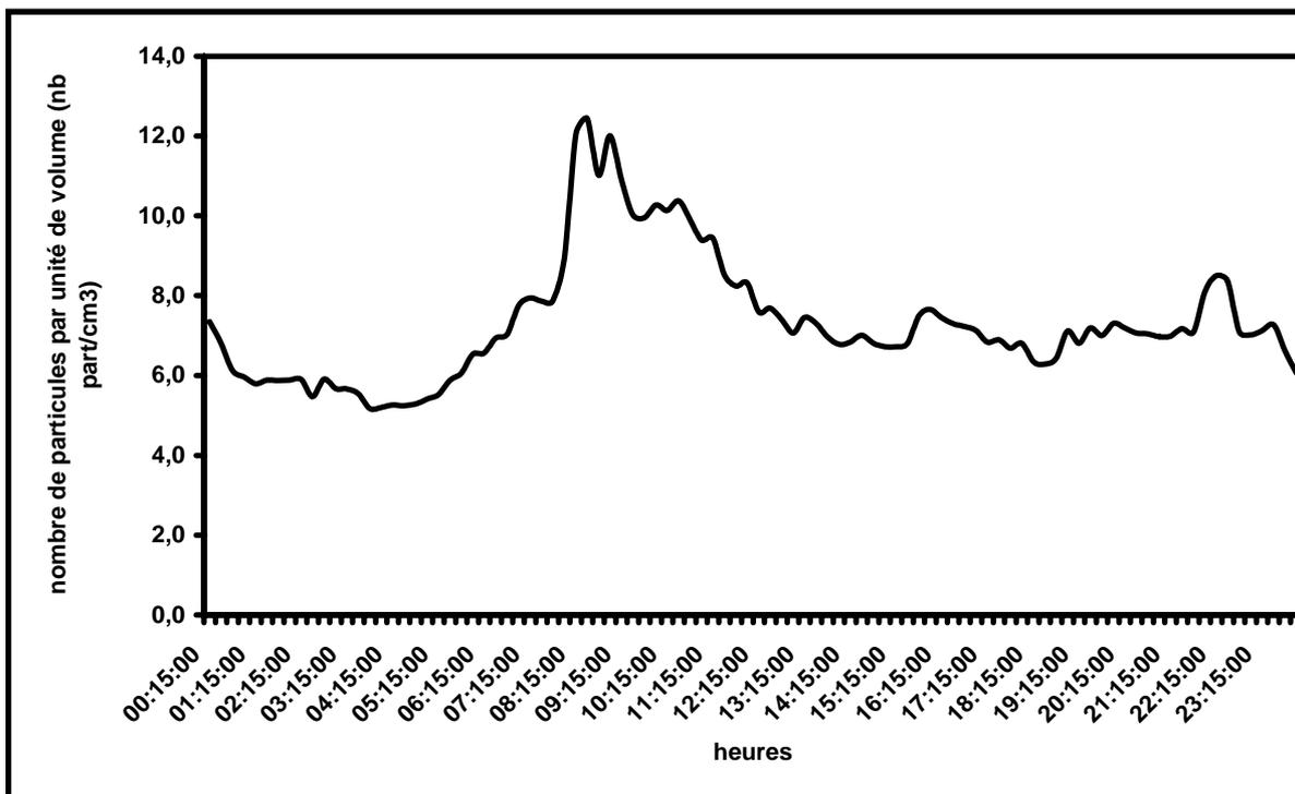
Figure n° III-6 : Evolution du nombre de particules ( $< 1\mu\text{m}$ ) par unité de volume en fonction du temps. Cette figure est issue des comptages du compteur optique ROYCO installé au site 2. Moyenne réalisée sur 21 jours de prélèvement avec un écart-type appartenant à l'intervalle 4.4 et 16.4.
