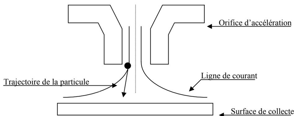
Figure n°II-4 : Principe de la collection par impaction
