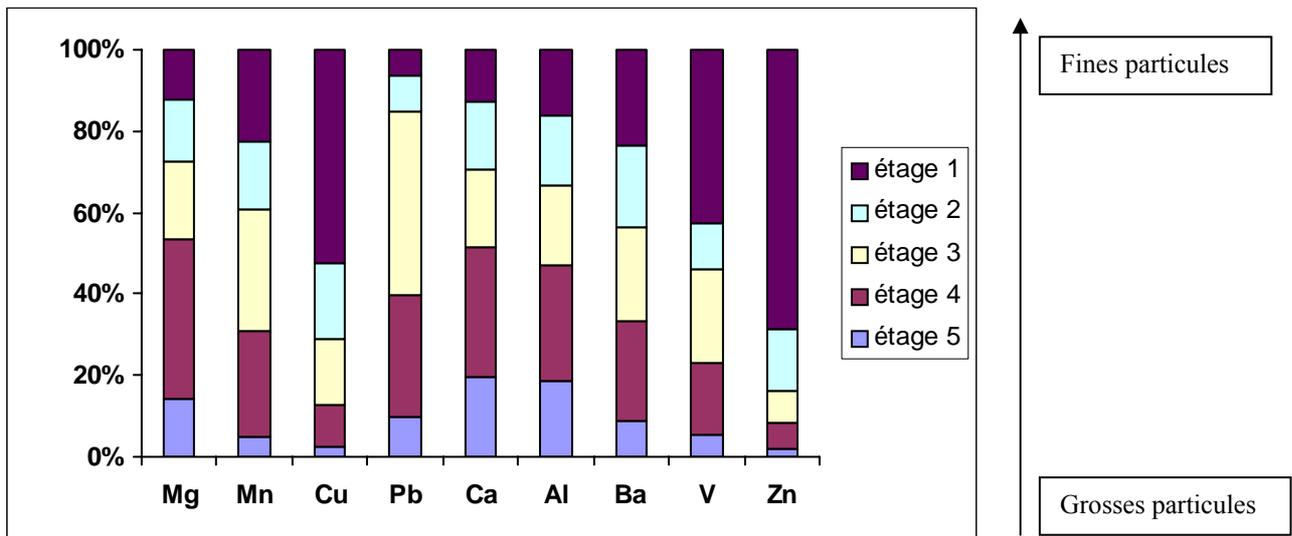
Figure n°V-5 : Pourcentage moyen de la fraction échangeable des concentrations élémentaires en fonction de la granulométrie des particules
