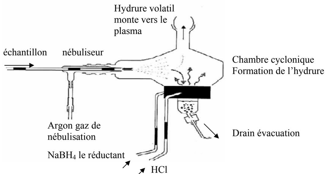
Figure n°II-7 : principe de la chambre « CMA »
