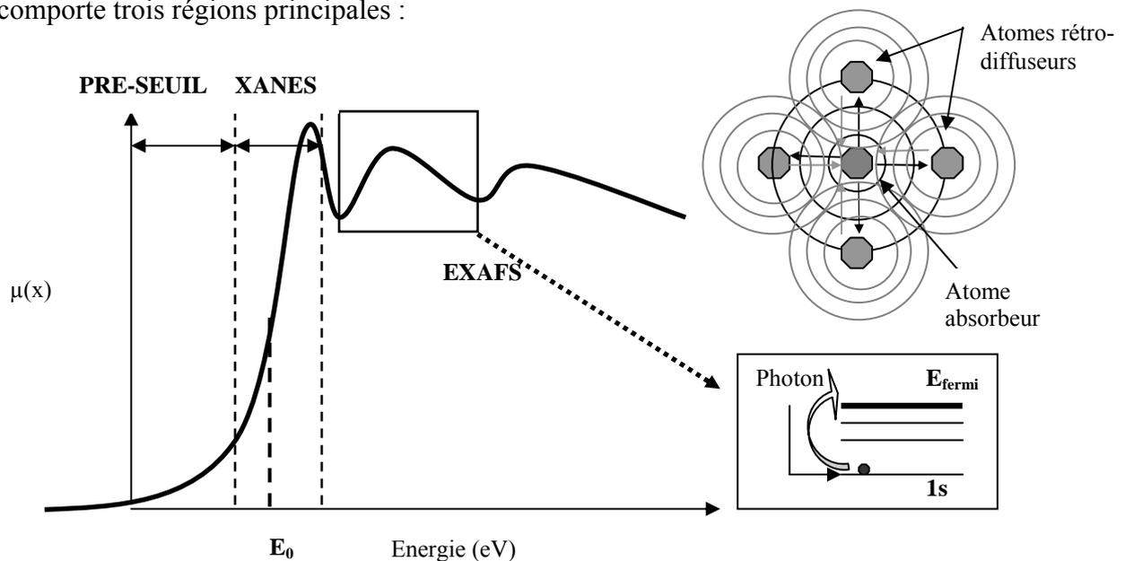
Figure n°V-1 : Spectre d'absorption des rayons X
