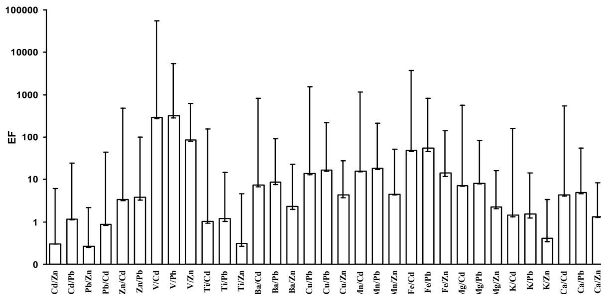
Figure n°III- 8: Facteur d'enrichissement des particules atmosphériques, PM<sub>10</sub>, par rapport aux cendres de l'incinérateur (Cd/Pb et Zn). Les barres d'erreur représentent les extréma et le sommet des histogrammes la médiane.
