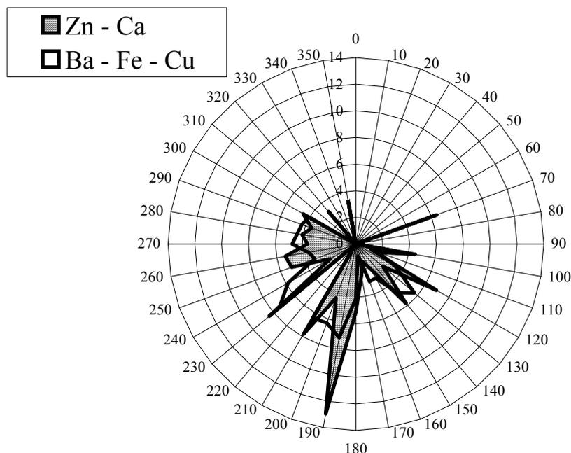
Figure n° IV- 9 : Rose des contributions des sources Zn – Ca et Ba – Cu – Fe réalisée aux sites 1, 3, 5 situés au nord de l’UIOM.
