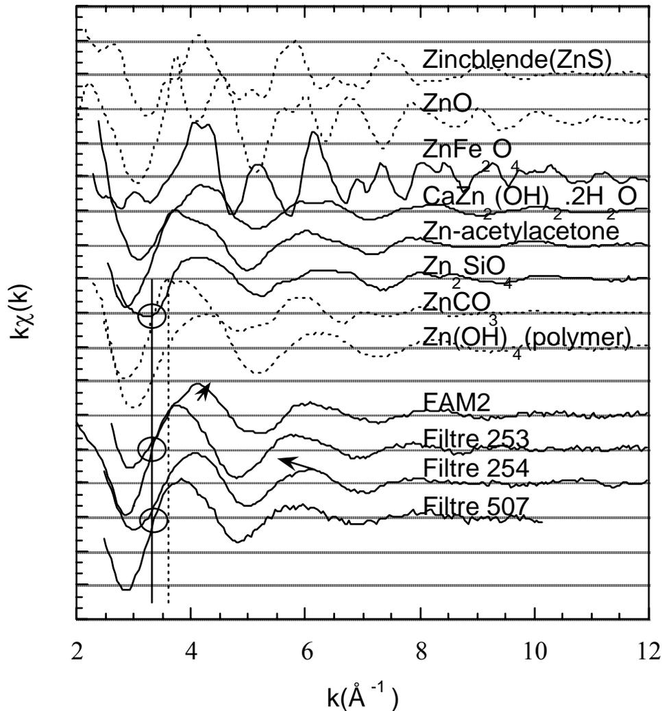
Figure n°V-15 : Spectre EXAFS du Zn dans les échantillons et les composés de référence
