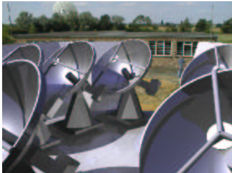
Fig. 2.5: Vue d'artiste de l'interféromètre AMI. L'instrument est constitué de 10 antennes de 3,7m de diamètre et fonctionne à 15 GHz. La figure est extraite du site Internet de AMI (voir tableau 2.2).
