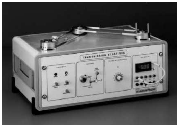
FIG. 6.29: Un exemple de système de transmission flexible.
