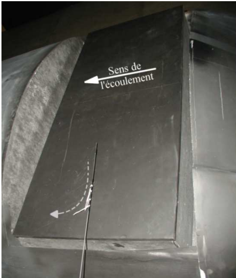
FIG. 3.9 – Visualisation des tourbillons contra-rotatifs au-dessus du rhéostat par la méthode des fils de laine.
