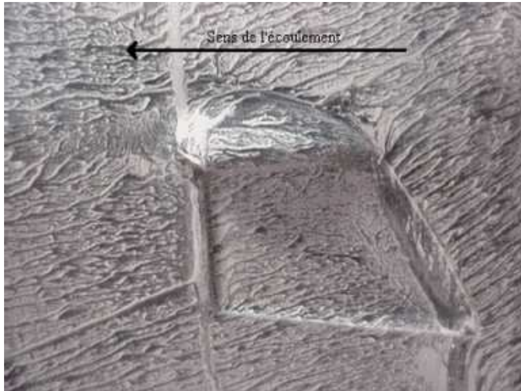
FIG. A.18 – Exemple de visualisation par enduit gras. Détail de la fenêtre conducteur du concept CORADIA DUPLEX.
