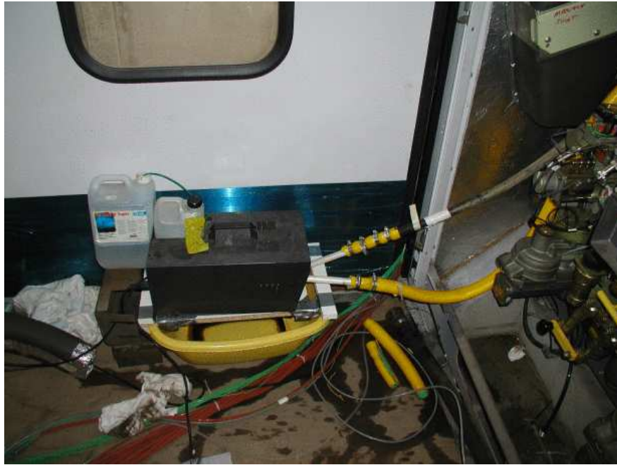
FIG. 3.38 – Dispositif d'ensemencement utilisé au cours des essais en ligne.
