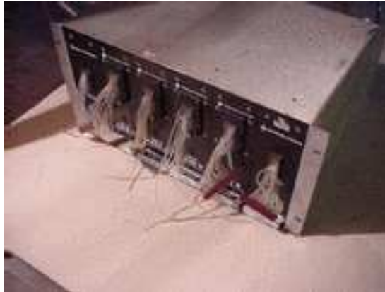
FIG. A.10 – Les 6 modules capteurs à 16 voies de la chaîne de mesure.
