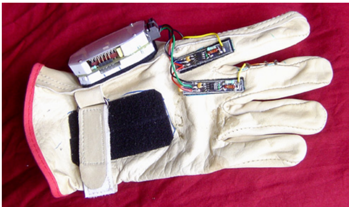
Figure 124. Second prototype du gant, de petite taille pour les mains des participants féminins.
