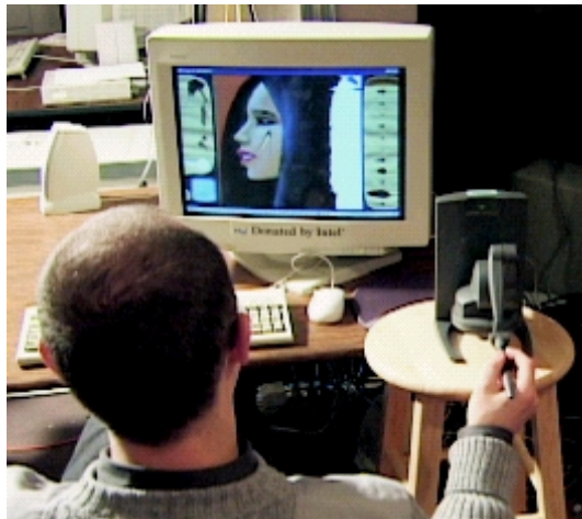
Figure 44. Exemple d'application d'un dispositif à retour d'effort pour la simulation de peinture artistique.
