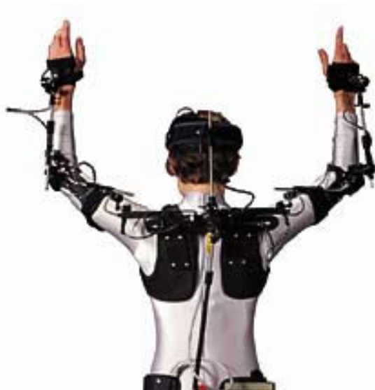
Figure 55. Partie scapulaire d'un exosquelette d'animation.
