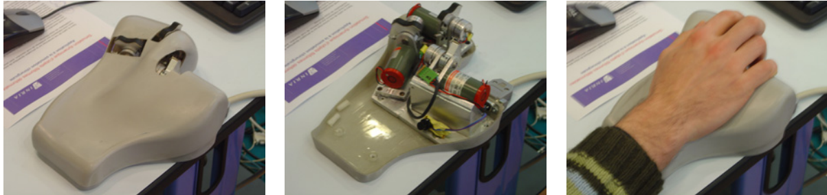
Figure 50. Dispositif « DigiHaptic » de contrôle de locomotion ou de manipulation.
