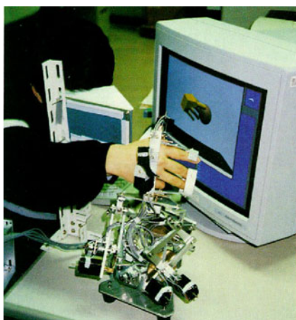
Figure 45. Le manipulateur à 9DOF.
