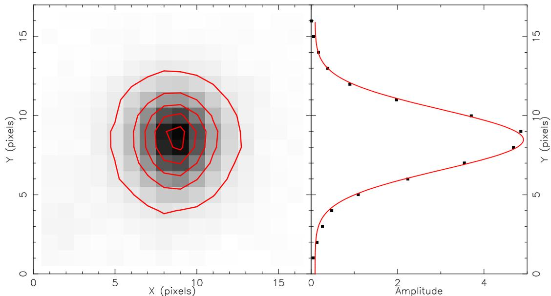
**Fig. 2.8:** A gauche : superposition des 5 étoiles (normalisées) les plus proches du point arbitraire (2000,2000) sur l'image R d'Abell 1689, avec contours d'intensité de 0.5 à 4.5 incrémentsés par pas de 1. A droite : coupe selon l'axe  $x = 9$ . Une gaussienne (d'amplitude 4.82 et de dispersion  $\sigma$  1.91) a été ajustée à cette coupe.
