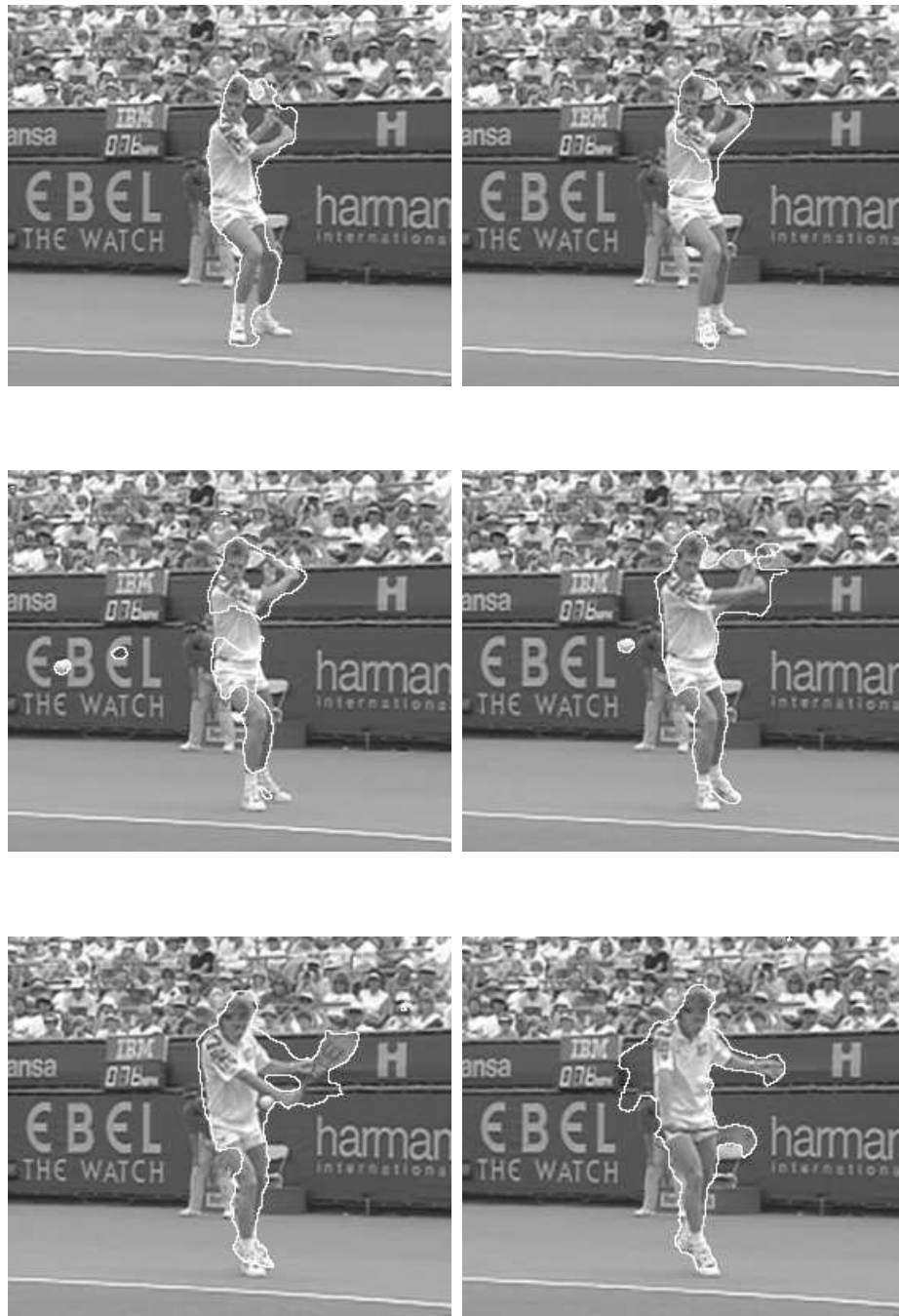
FIG. 4.10: Résultats de notre méthode de segmentation par flot optique pour les paramètres suivants : \alpha = 1 , \lambda = 5 , \nu = 1 . Les mouvements non rigides ne favorisent pas l'utilisation de cette méthode. L'emploi d'un flot optique obtenu avec multirésolution permet toutefois d'obtenir un résultat certes approximatif, mais qui peut se combiner avec d'autres algorithmes.
