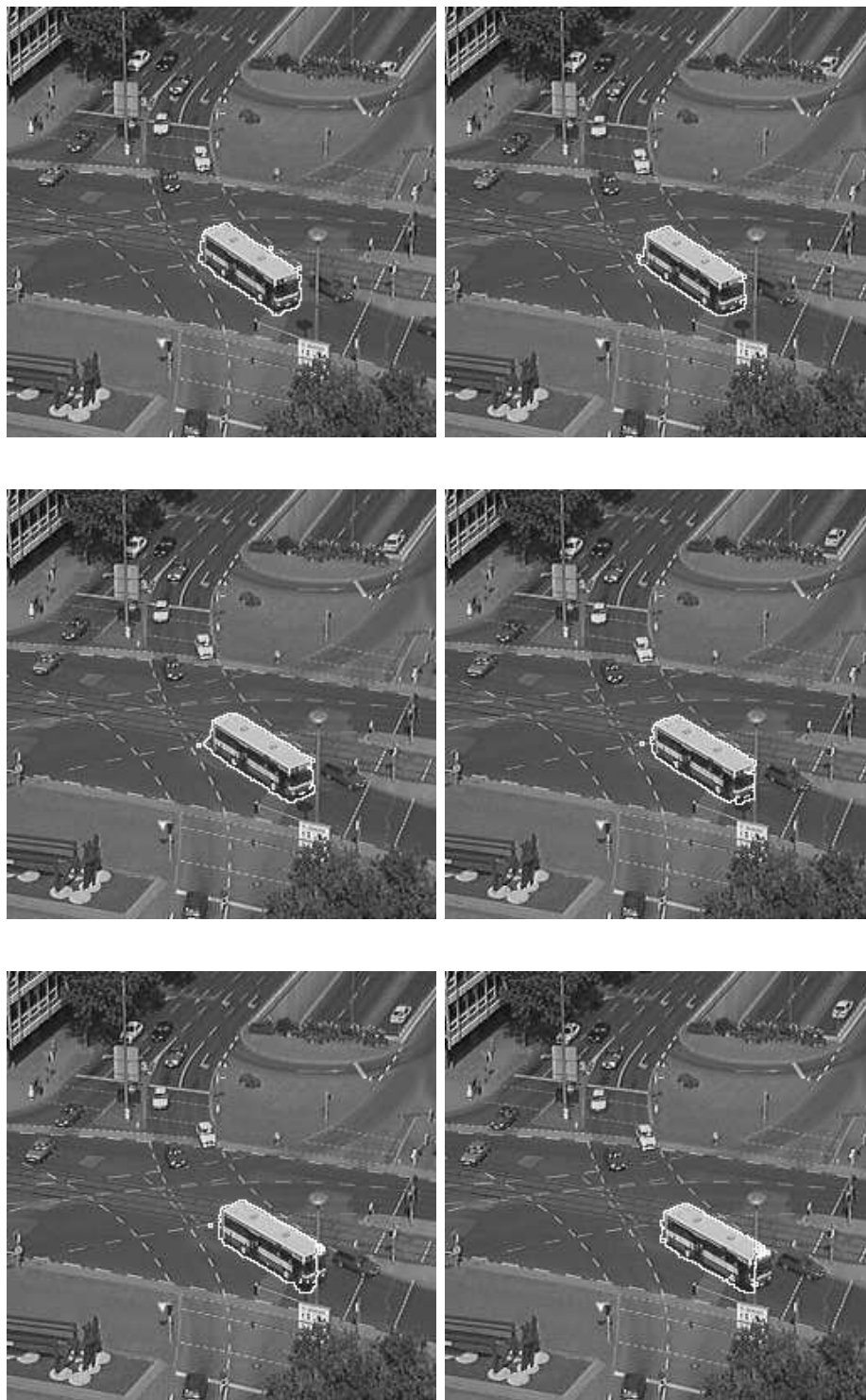
FIG. 3.15: Application de la méthode de tracking de Mansouri et al. par l'ICM. Images paires de la séquence de la 2 e à la 12 e : 5 balayages de l'ICM sont effectués, \lambda = 10 et \alpha = 3 .
