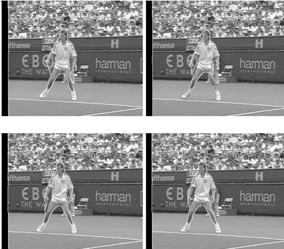
FIG. 4.6: Résultats de l'implémentation par EDP sur le modèle basé sur la différence entre une image et le fond ( \alpha_1 = 30 , \alpha_2 = 20 , \alpha_3 = 10 , \lambda = 75 , \delta t = 5 pour le pas de temps). Le résultat est meilleur, grâce notamment à la disparition d'effets de blocs ( aliasing ) du contour.
