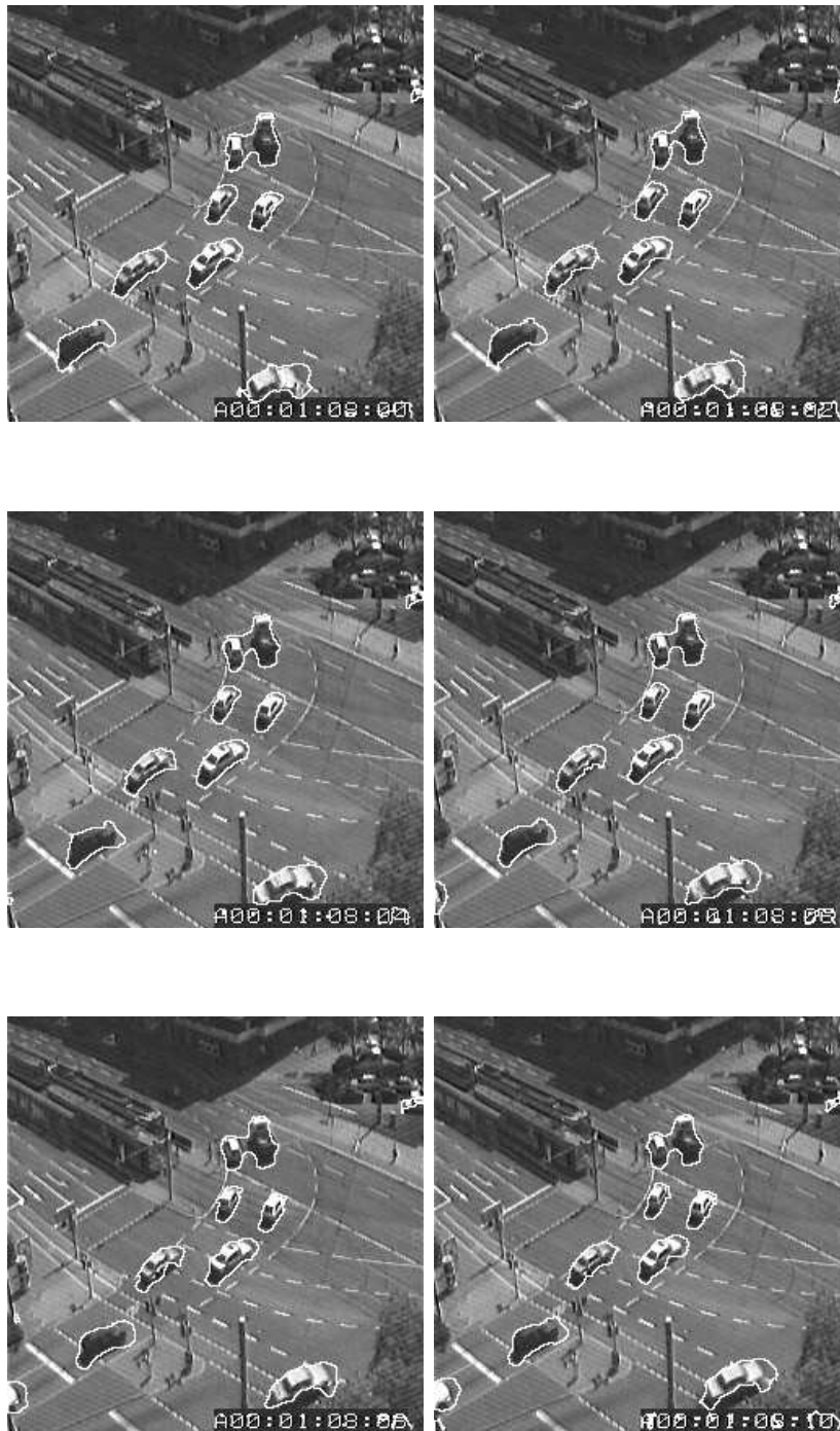
FIG. 3.26: Résultats de notre modèle de segmentation avec flot optique sur les images paires de la séquence (de la 2 e à la 12 e ). Les paramètres sont \alpha = 0,6 , \nu = 0,2 , \lambda = 2 , \epsilon = 1 et \Delta t = 5 pour le pas de temps.
