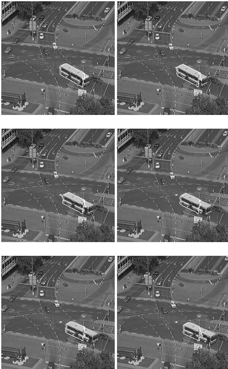
FIG. 3.16: Suite de la figure 3.15. Application de la méthode de tracking de Mansouri et al. par l'ICM. Images paires de la séquence de la 14 e à la 24 e : 5 balayages de l'ICM sont effectués, \lambda = 10 et \alpha = 3 . L'algorithme n'est pas robuste aux occultations : le poteau occultant le bus empêche l'algorithme d'effectuer correctement le suivi.
