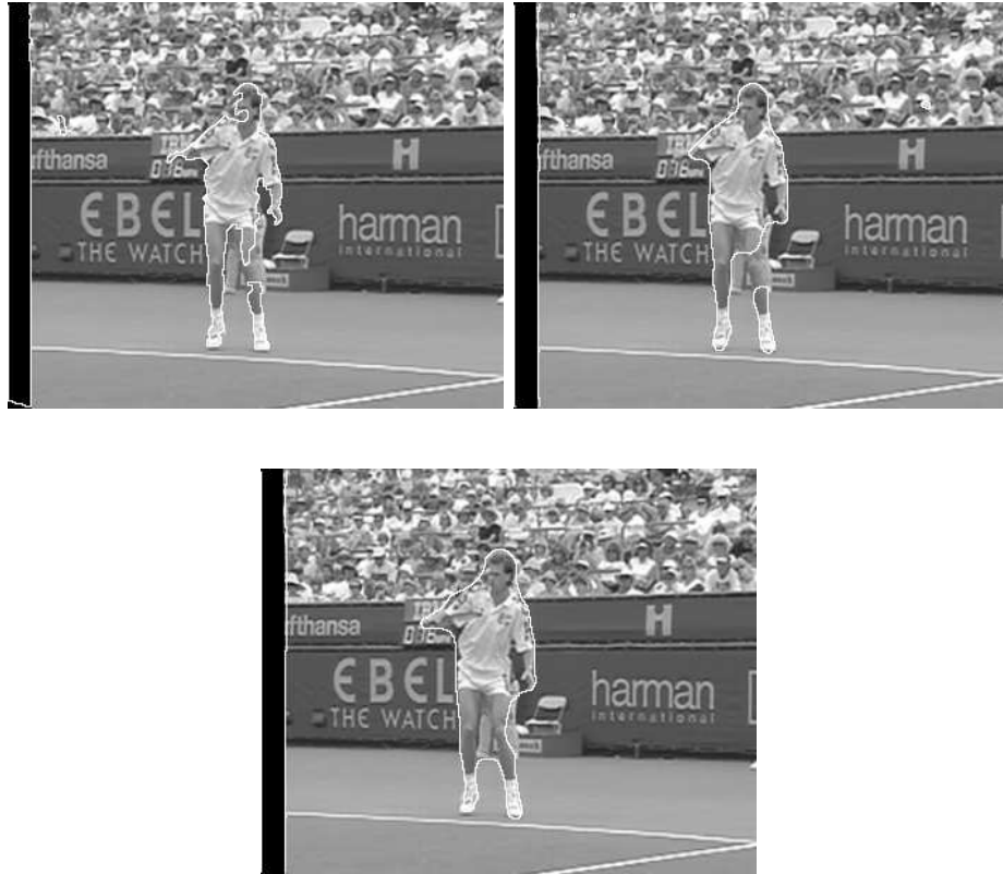
FIG. 4.9: Modèle basé sur la différence entre une image et le fond ( \alpha_1 = 30 , \alpha_2 = 20 , \alpha_3 = 10 , \lambda = 75 , \delta t = 5 pour le pas de temps). Cas où le résultat de l'EDP seule (deuxième image) est amélioré par l'application préalable de l'ICM (troisième image). La première image montre le résultat de l'ICM seul.
