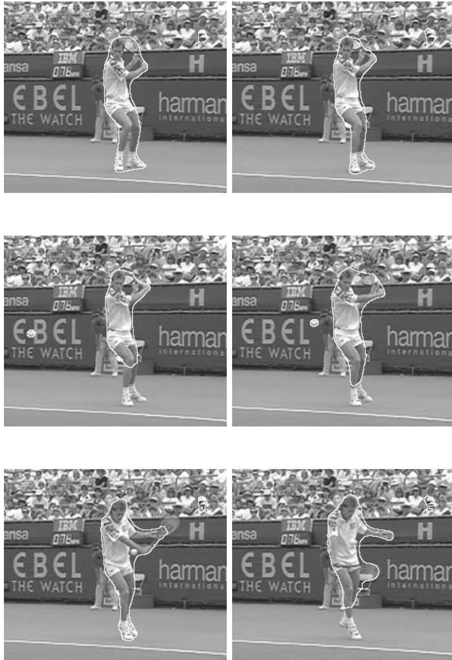
FIG. 4.12: Résultats obtenus pour le modèle de segmentation par comparaison entre l'image et le fond en appliquant l'ICM et l'EDP ( \alpha_1 = 30 , \alpha_2 = 20 , \alpha_3 = 10 , \lambda = 75 , \delta t = 5 pour le pas de temps). A comparer avec la figure précédente.
