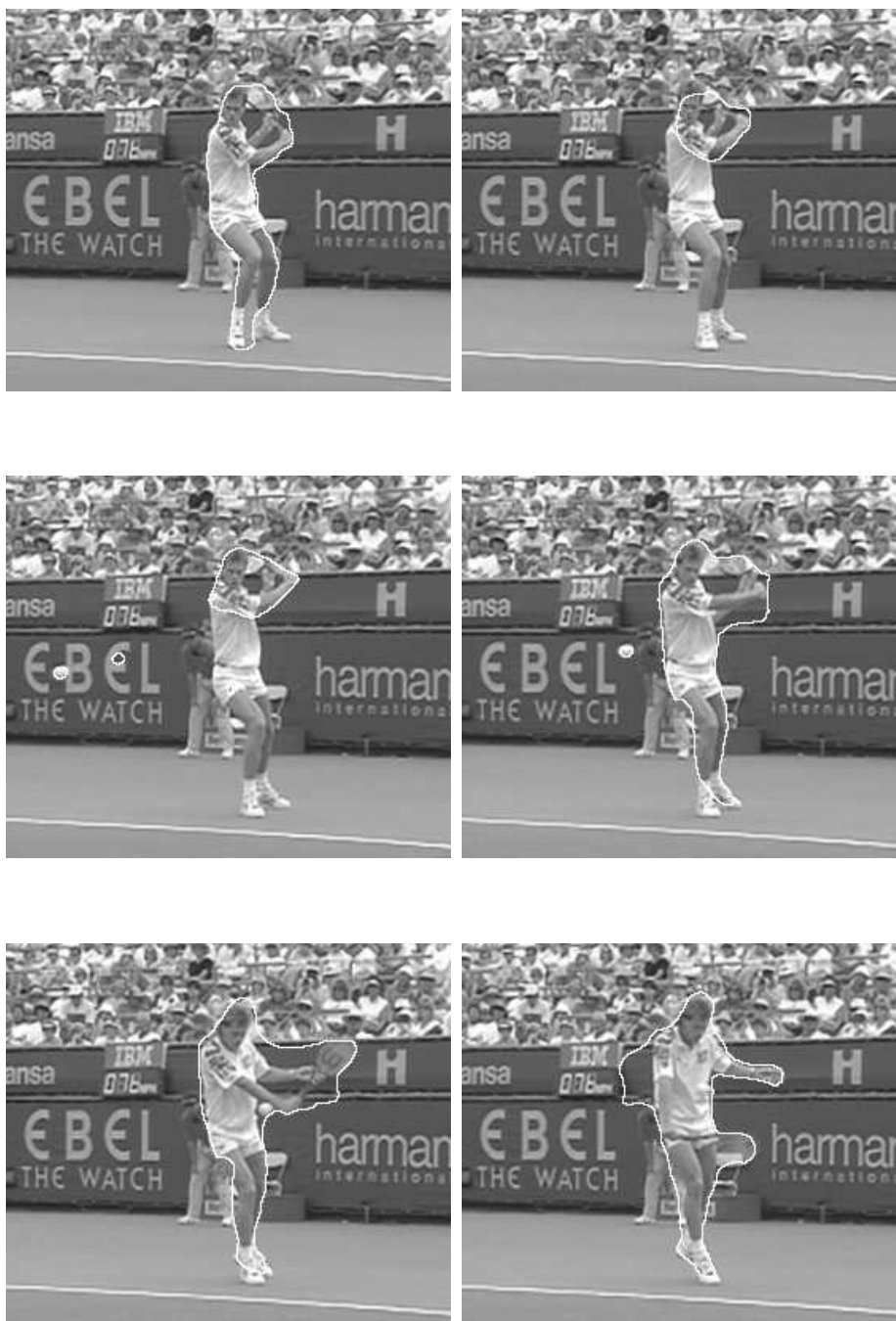
FIG. 4.11: Résultats de notre méthode de segmentation par flot optique pour les paramètres suivants : \alpha = 1 , \lambda = 25 , \nu = 5 . Les mouvements non rigides ne favorisent pas l'utilisation de cette méthode. A comparer avec la figure précédente (les paramètres sont plus élevés, la courbe est donc plus proche des bords des objets).
