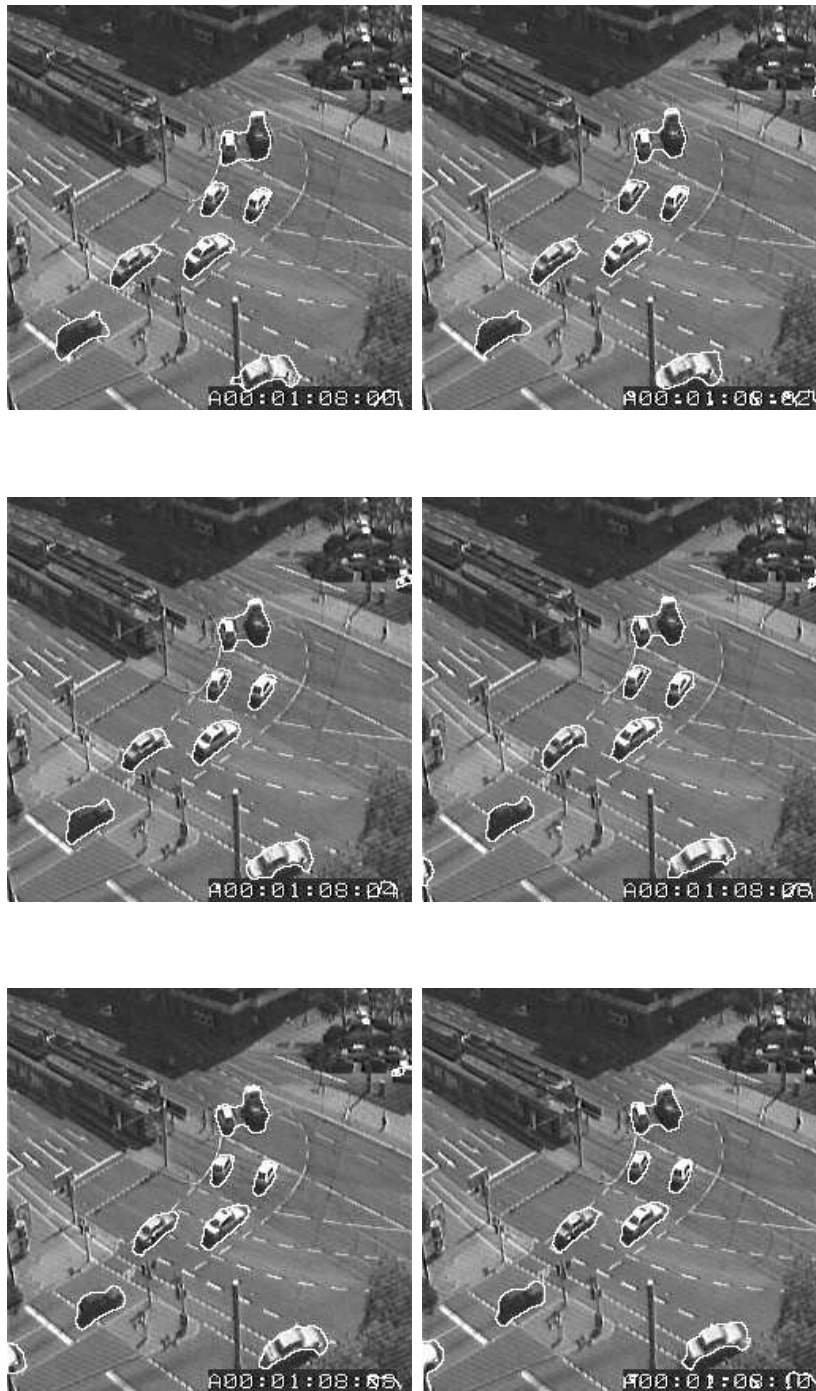
FIG. 3.28: Résultats de notre modèle de segmentation avec flot optique sur les images paires de la séquence (de la 2 e à la 12 e ). Par rapport à la figure 3.26, les paramètres ont été changés en \nu = 1 et \lambda = 15 . Remarquer que l'effet des zones homogènes a disparu (voiture en bas à gauche), le coefficient \lambda plus élevé qu'en figure 3.26 permettant d'attirer la courbe vers les bords des voitures.
