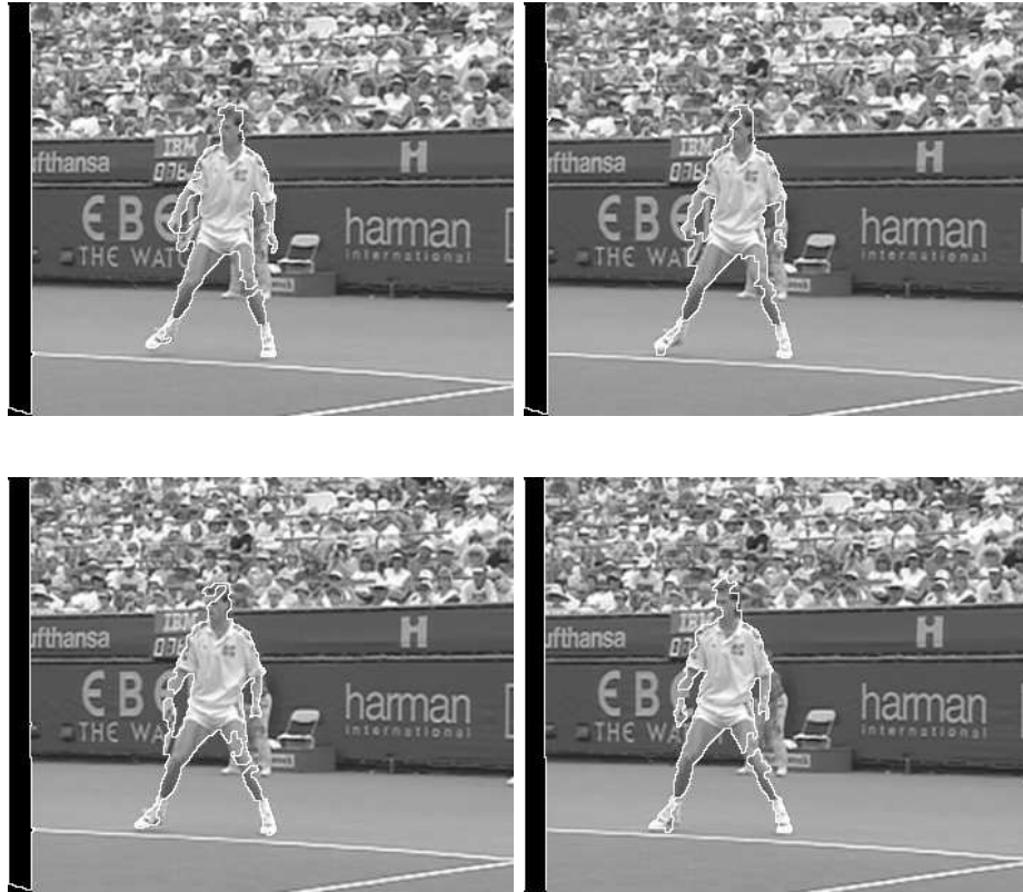
FIG. 4.5: Résultats de l'implémentation par ICM sur le modèle basé sur la différence entre une image et le fond ( \alpha_1 = 30 , \alpha_2 = 20 , \alpha_3 = 10 , \lambda = 75 , 5 balayages de l'ICM). Le résultat est évidemment bien meilleur qu'en utilisant simplement la différence avec l'image précédente (comparer avec la figure 4.3).
