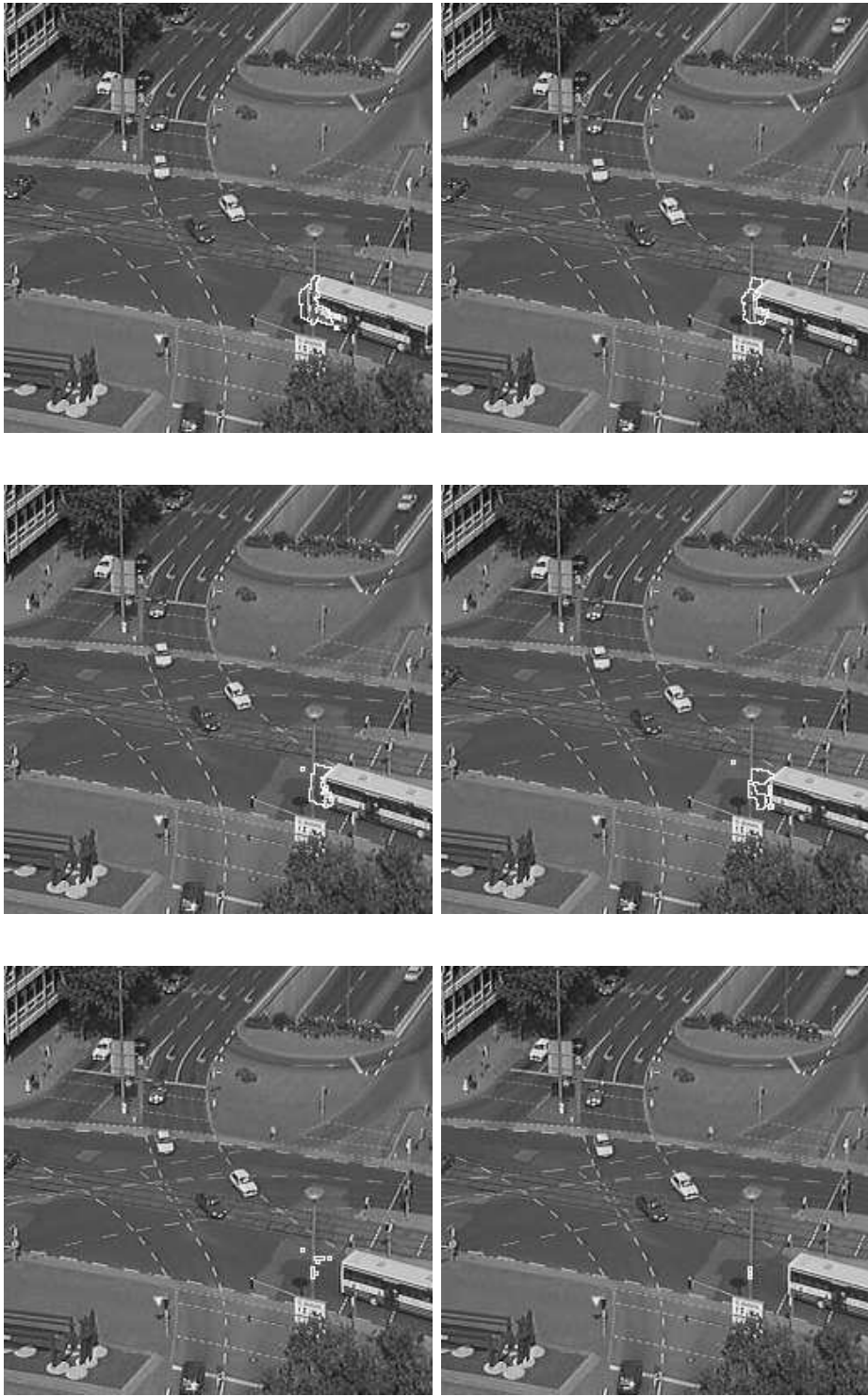
FIG. 3.18: Suite de la figure 3.17. Application de la méthode de tracking de Mansouri et al. par l'ICM. Images paires de la séquence de la 38 e à la 48 e : 5 balayages de l'ICM sont effectués, \lambda = 10 et \alpha = 3 . Le suivi échoue complètement à partir du moment où le bus s'éloigne du poteau.
