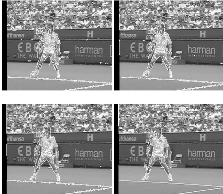
FIG. 4.3: Résultats du modèle basé sur la différence entre deux images successives sur plusieurs images consécutives de la séquence “Edberg” ( \alpha = 10 , \lambda = 50 , 5 balayages de l’ICM). Le résultat est assez bruité et comporte des “trous” car certaines zones (le T-shirt) sur le joueur sont trop homogènes en niveau de gris.
