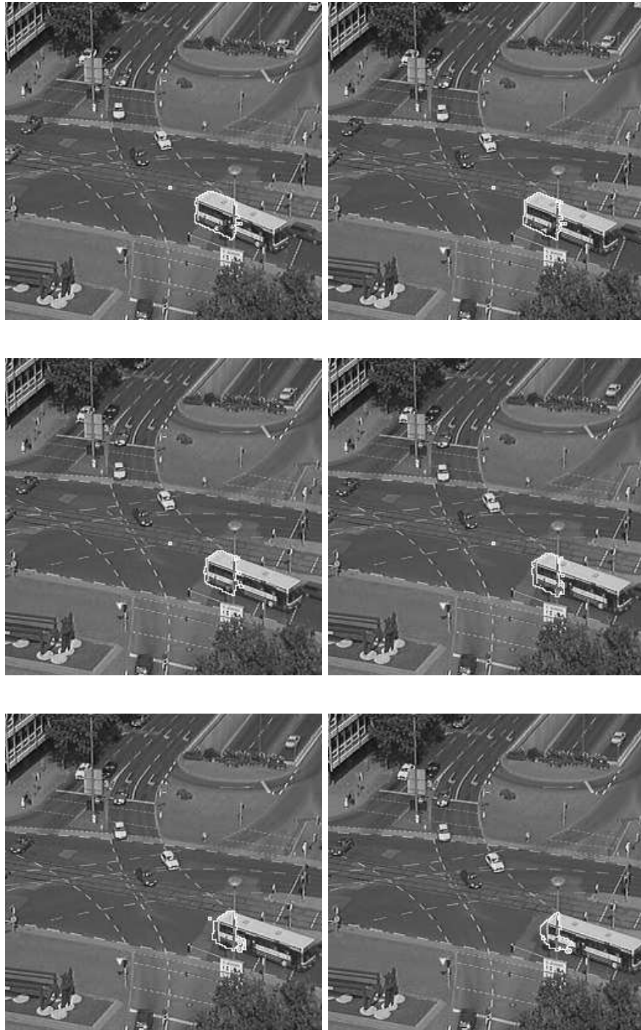
FIG. 3.17: Suite de la figure 3.16. Application de la méthode de tracking de Mansouri et al. par l'ICM. Images paires de la séquence de la 26 e à la 36 e : 5 balayages de l'ICM sont effectués, \lambda = 10 et \alpha = 3 . L'algorithme n'est pas robuste aux occultations : le poteau occultant le bus empêche l'algorithme d'effectuer correctement le suivi.
