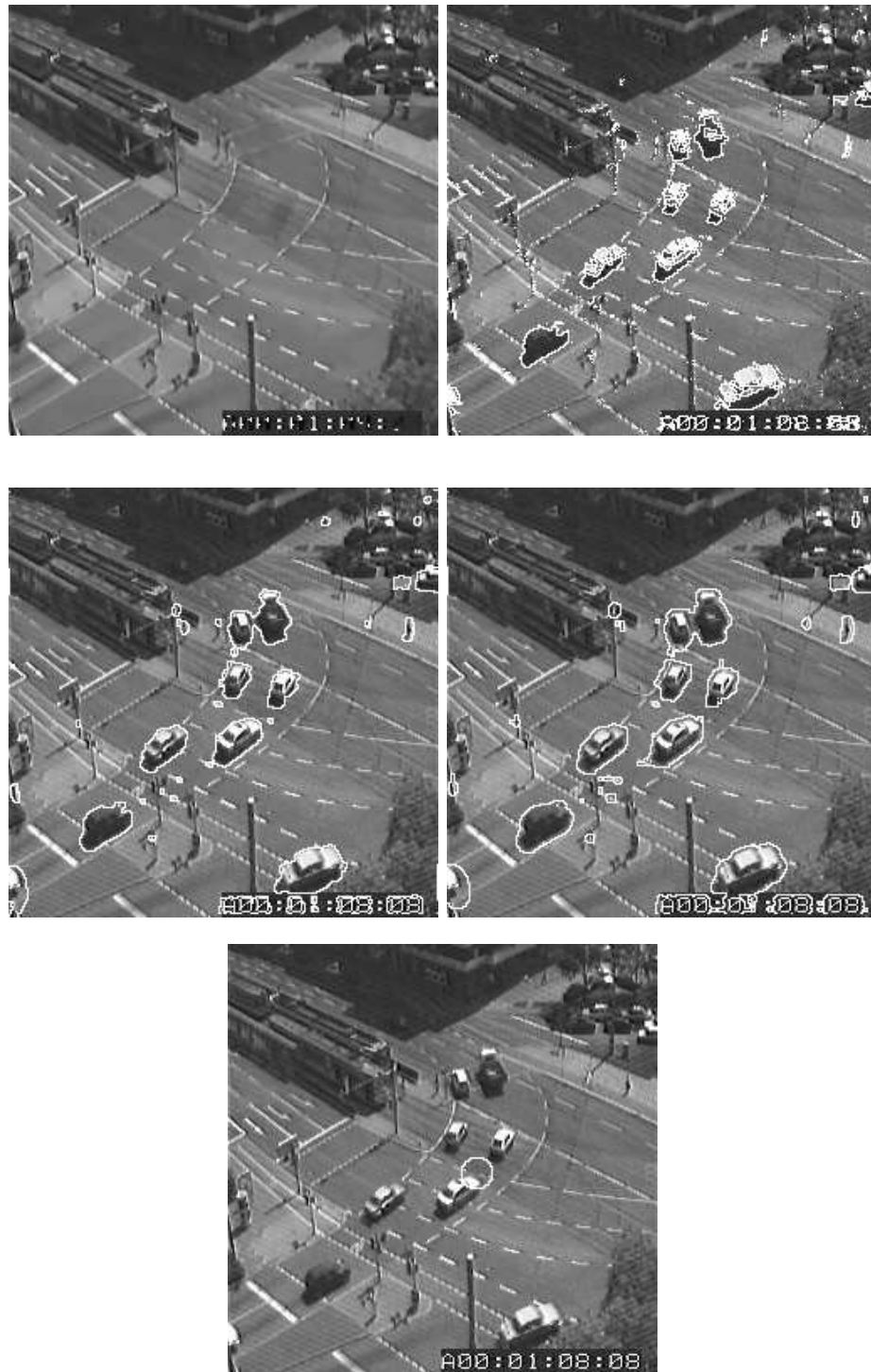
FIG. 3.8: En haut, l'image du fond et la segmentation obtenue par le seuillage |B - I_h| > \alpha , au milieu et à droite : segmentation par l'algorithme Aubert–Barlaud–Jehan–Besson pour \lambda = 10 et \lambda = 20 ( \delta t = 5 , \epsilon = 1,5 , \alpha = 20 , l'initialisation choisie est montrée sur l'image du bas). Le paramètre \lambda permet de régulariser le résultat du seuillage |B - I_h| > \alpha .
