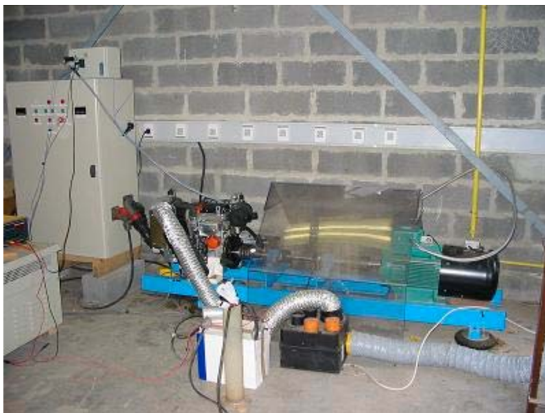
Figure 63 : Banc d'essais moteur du LAMIH
