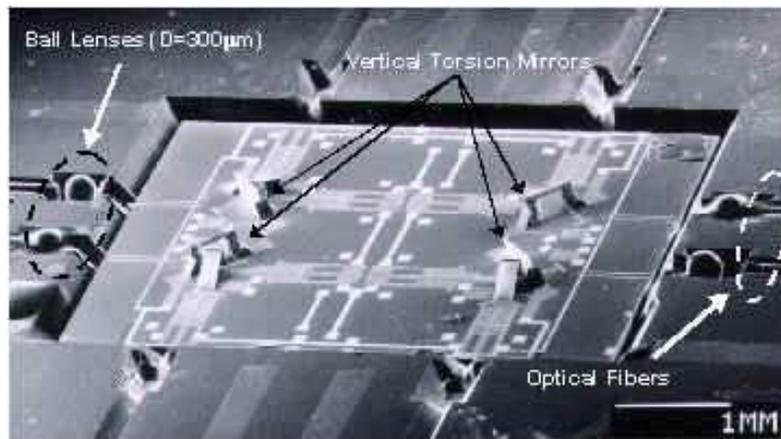
FIG. 3.10 – Commutateur  $2 \times 2$  pour fibre optique
