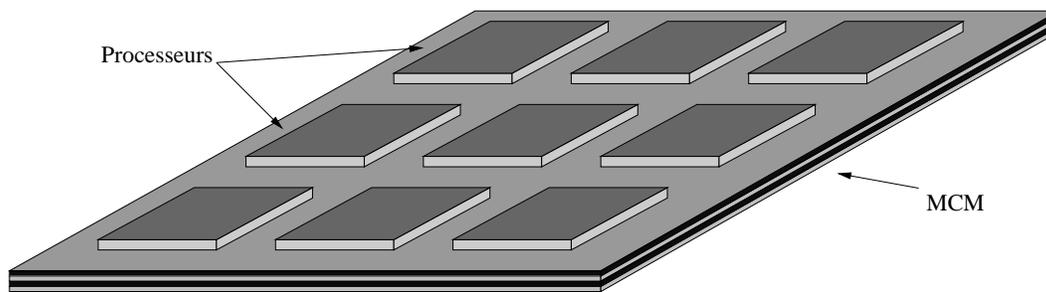
FIG. 3.2 – Schéma d'un MCM supportant 9 processeurs.
