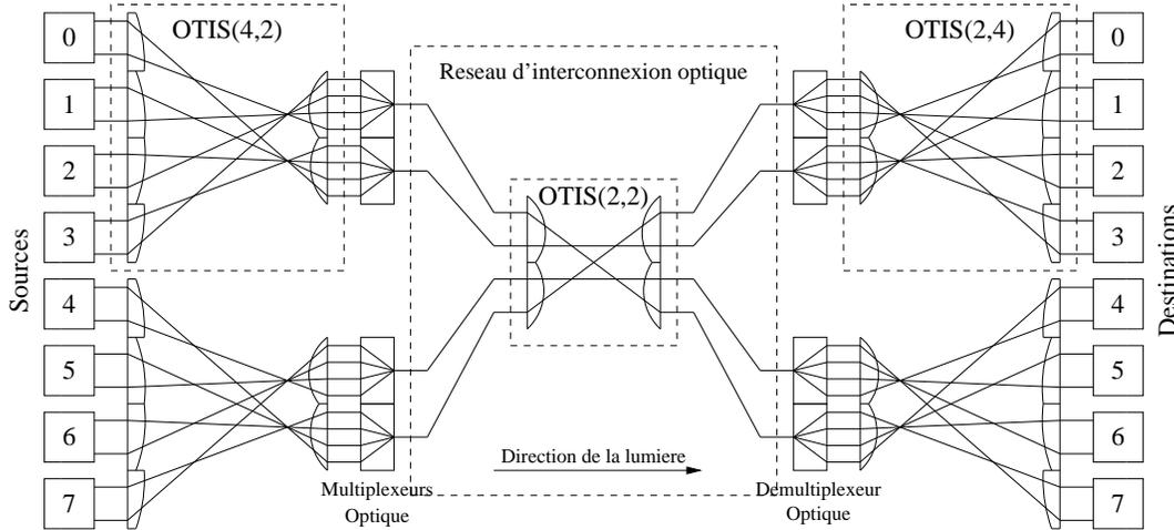
FIG. 6.12 –  $POPS(4, 2)$  réalisé avec OTIS.
