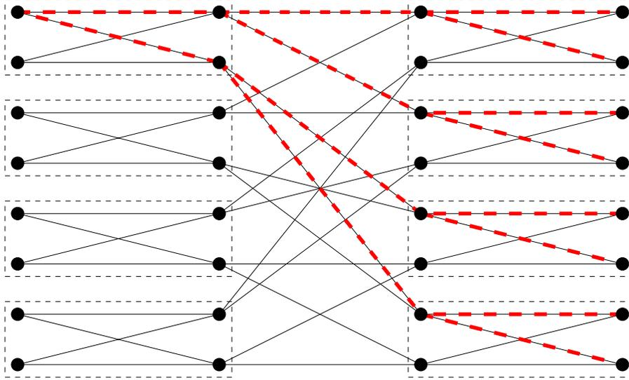
FIG. 2.6 – Réseau papillon  $\overrightarrow{BF}(2, 3)$ , construit comme  $\overrightarrow{K}_{4,4} [\overrightarrow{BF}(2, 1)]$ .
