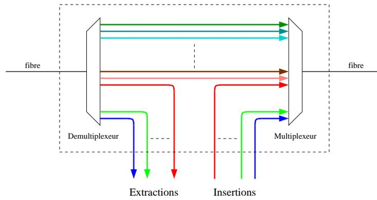
FIG. 3.16 – Multiplexeur à insertions/extractions optiques.
