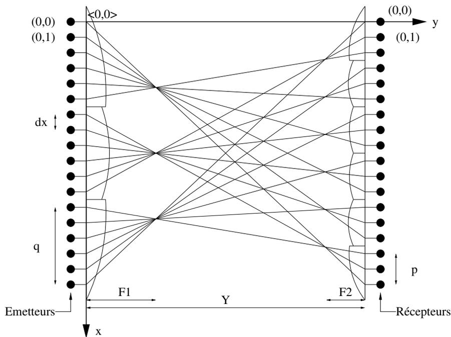
FIG. B.1 – Paramètres sur  $OTIS(3, 6)$ .
