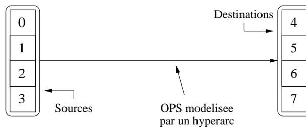
FIG. 6.1 – Modélisation d'une OPS par un hyperarc.
