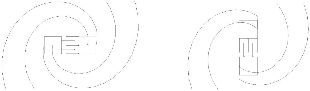
FIG. 2.31: Intégration du photodétecteur P_1 au centre de S_2 et S_3
