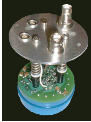
FIG. 2.11 – Photo d’une base de photomultiplicateur français
