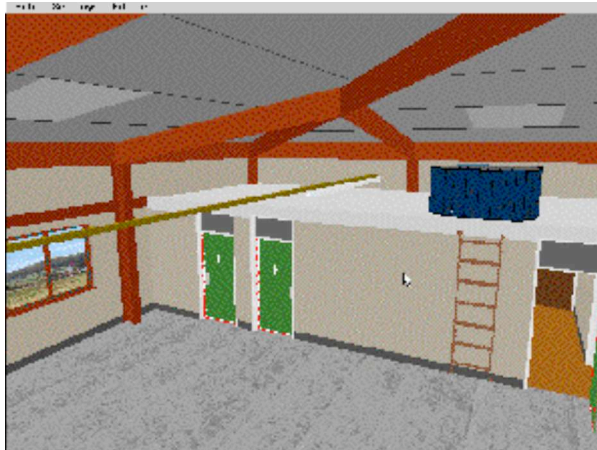
Figure 25: l'accès du réservoir est facilité par l'échelle.
