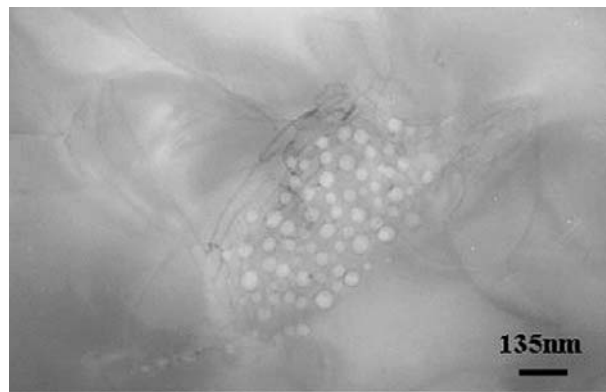
Figure III-3 : Mise en évidence d'un groupe ou cluster de cavités obtenu avec une dose de 2 \cdot 10^{16} He / cm 2 et un recuit de 900°C / 30 min.
