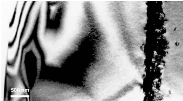
Figure IV-13 : Vue générale de la bande de défauts sur fond noir créés avec une fluence de 5.10^{16} He / cm 2 et une feuille d'aluminium de 1,5 \mu\text{m} après un recuit de 800°C / 30 min.
