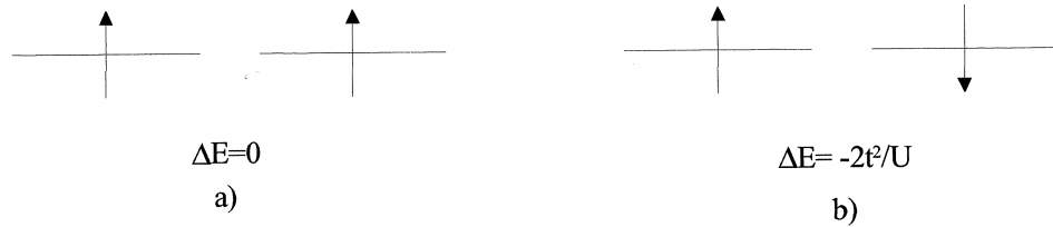
Fig. 2-9 : Deux sites voisins avec les spins parallèles a) et antiparallèles b). Le gain d'énergie \Delta E du saut virtuel d'un électron sur le site voisin est indiqué.
