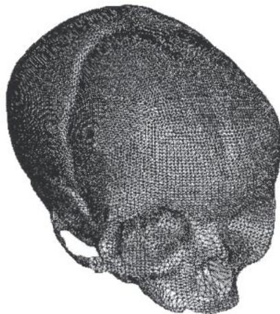
**Figure 1.43** Modèle en éléments finis du crâne développé par Lapeer [LAP01]
