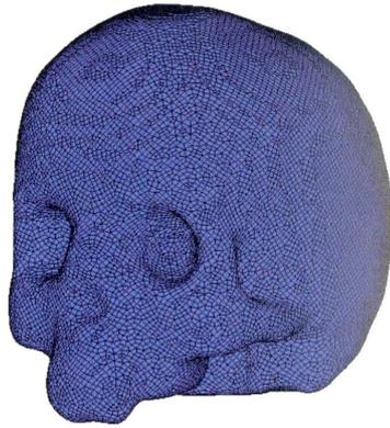
**Figure 1.38** Modèle en éléments finis du crâne et de la face réalisé par Dellile et Bidal [DEL02] [BID03]
