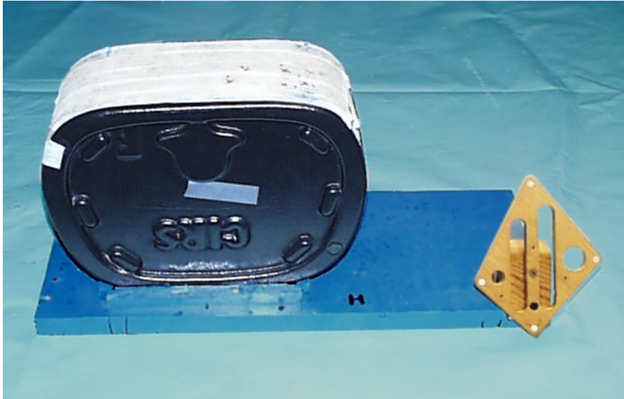
FIG. 8.13 – Fantôme abdominal solidarisé du corps rigide de référence. Le fantôme est placé en décubitus ventral.
