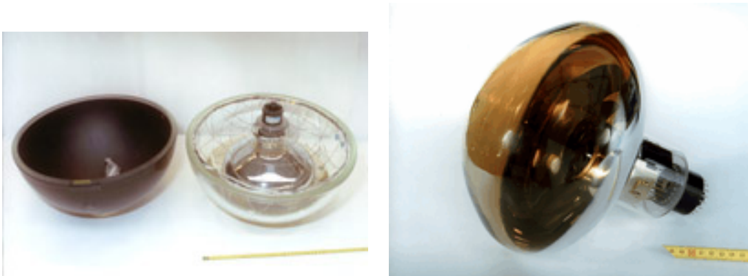
FIG. 2.8 – OM et Photomultiplicateur Hamamatsu R7081-20
