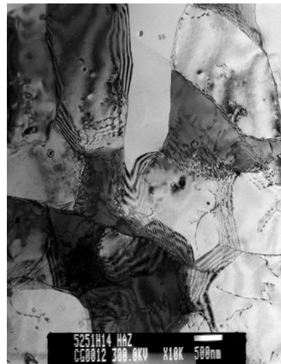
Fig.III.66 Sous-grains restaurés dans la ZAT. Image MET en champ clair
