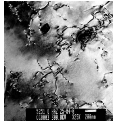
Fig.III.8 Population de dislocations dans les zones de transition. Image MET en champ clair (2 ondes)
