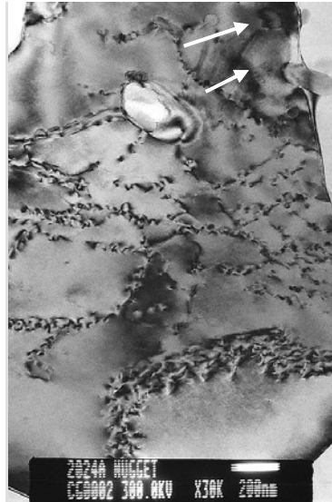
Fig.III.46 Ancrage des joints de grain par des dispersoïdes. Image MET en champ clair
