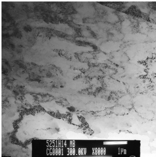
Fig.III.65 Sous-grains dans l'alliage 5251 H14. Image MET en champ clair
