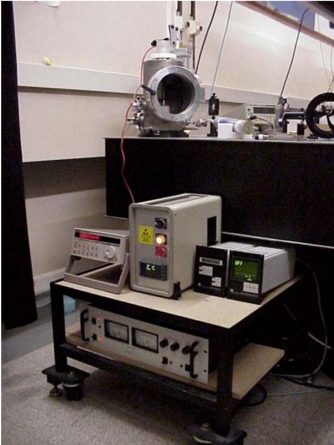
Figure 8 : vue d'ensemble du montage de poling sur la table optique ainsi que les appareils de contrôle (du bas vers le haut et de gauche à droite : alimentation haute tension, picoampèremètre, régulateur de température et jauge de vide secondaire)
