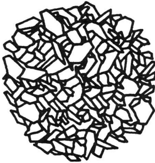
FIG. 9.17 – Exemple d'agrégat structure d'un agrégat de plaquettes, bloquées dans une architecture poreuse en château de cartes par les forces de frottement
