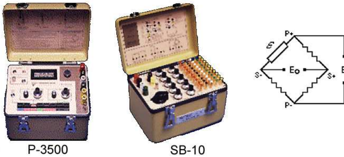
FIG. D.1 – Photographies des deux unités de contrôle des jauges et schéma du montage quart de pont
