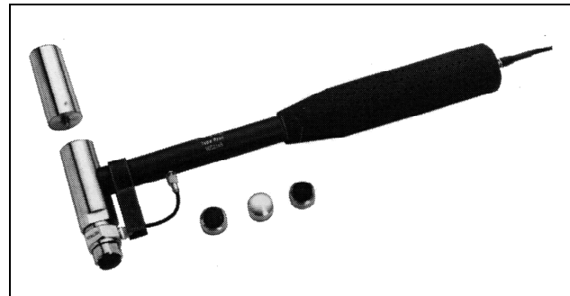
Figure 149 : Marteau – force Brüel & Kjaer de type 8202 avec les trois têtes d'impact en acier, plastique, et caoutchouc.
