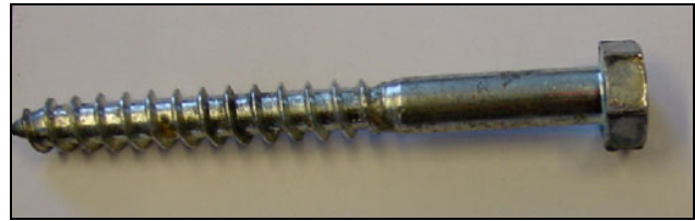
Figure 112 : Détail du support de l’accéléromètre et du support d’impact, vis tire-fond ( \varnothing 6 mm, longueur 4 cm).
