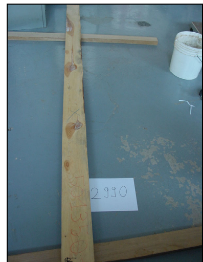
Figure 186 : Poutre de pin sylvestre testée par écholocation..
