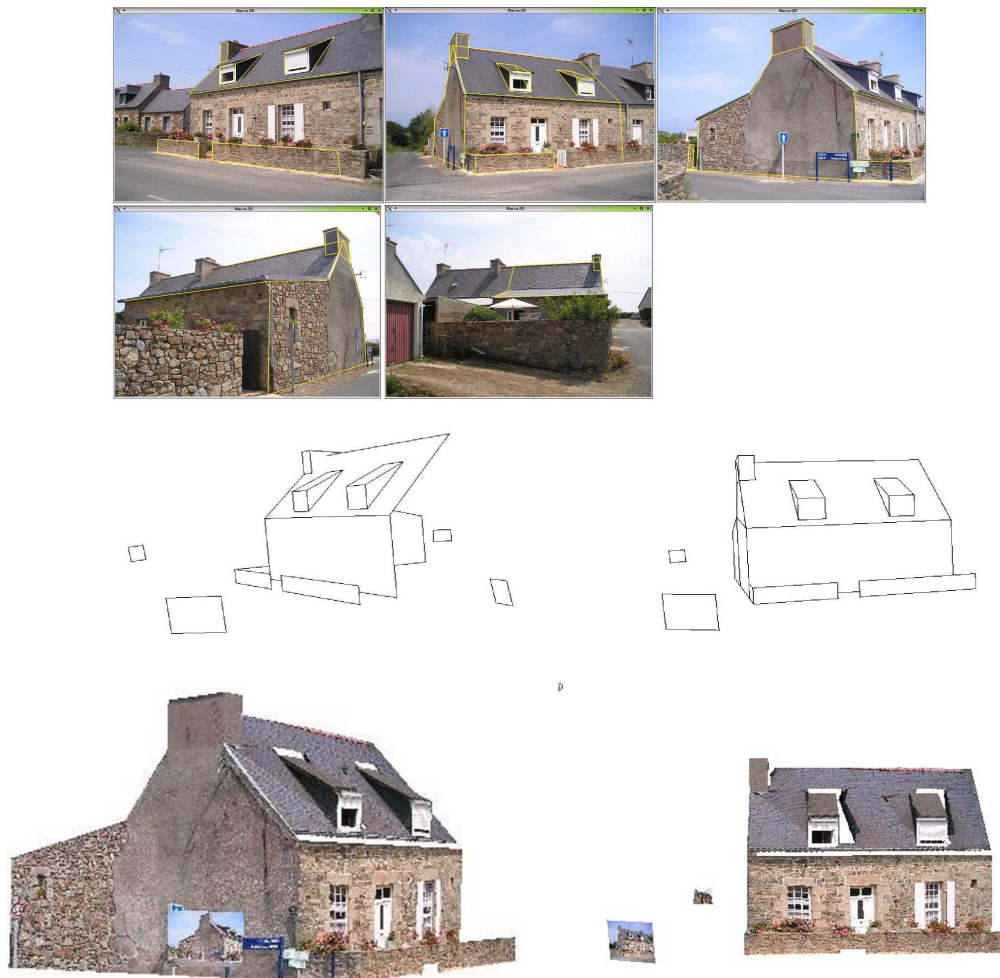
FIG. 5.21: Reconsruction de la maison bretonne. En haut, les images utilisées, au centre, le modèle obtenu rendu en fil de fer et en bas, le modèle final texturé. Dans les images du haut, seul les segments pour lesquels les deux extrémités ont été localisées manuellement dans les images sont représentés.
