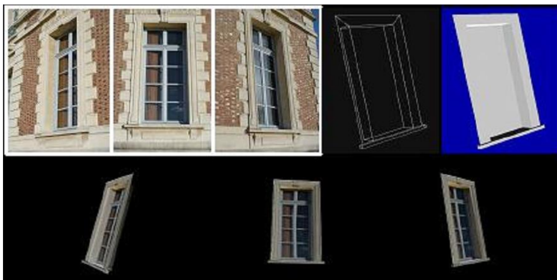
FIG. 5.7: Exemple de la fenêtre du rez-de-chaussée. Les trois images utilisées pour la reconstruction sont en haut à gauche. En haut à droite se trouve une image du modèle filaire obtenu et une image du modèle surfacique. Enfin, en dessous, il y a trois images du modèle texturé.
