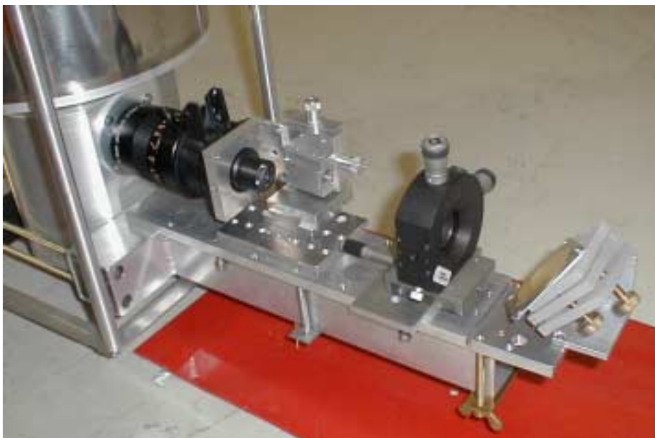
Figure 5 : Système optique en sortie du cryostat.
