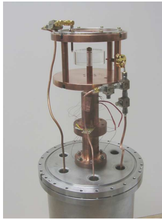
FIG. 4.17 – Photographie du contenu de l'insert cryogénique.
