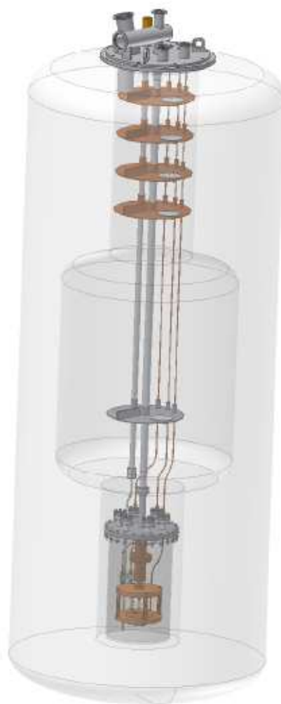
FIG. 3.2 – Représentation de l'insert cryogénique dans le cryostat.
