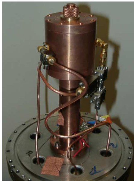
FIG. 5.24 – Photographie de la structure à résonateur compensé saphir-rutile.
