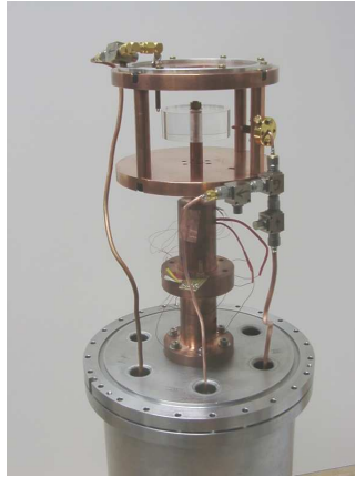
FIG. 4.16 – Photographie du contenu de l'insert cryogénique.
