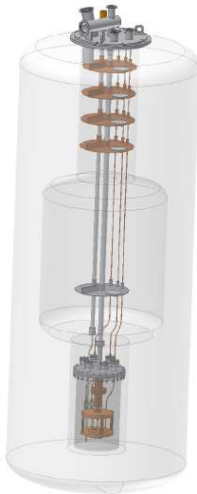
FIG. 3.2 – Représentation de l'insert cryogénique dans le cryostat.
