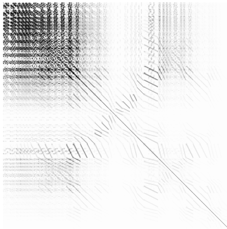
FIG. 51 – La matrice de rigidité dans la base de paquets d'ondelettes de V_h recouvrante de la figure 49.
