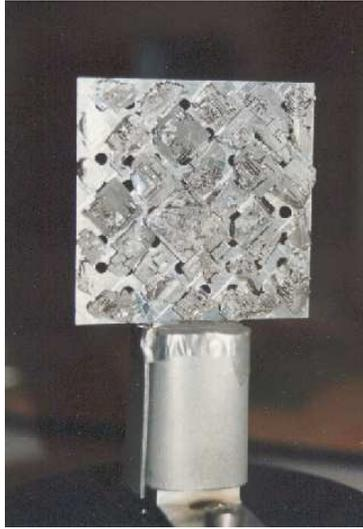
FIG. 8.1 – Montage expérimental de 30 monocristaux de  $\text{CeIn}_3$  alignés et collés sur une plaquette d'aluminium de  $45 \times 45 \text{ mm}^2$ , utilisé lors de l'expérience de diffusion des neutrons sur MARI.
