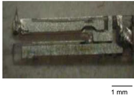
FIG. 6.3 – Photo du diapason sur lequel est collé une pointe de platine - iridium.
