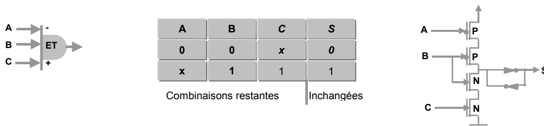
Figure 1.5c : Symbole, spécification, et implémentation de la porte de Muller dissymétrique [RIGA 02]
