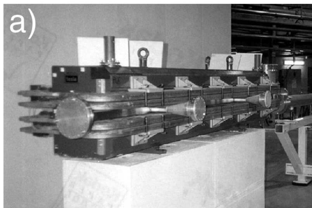
Fig. II.9 – Photographies de différents aimants de courbures du synchrotron ESRF, Grenoble, France : (a) wiggler ; (b) onduleur.
