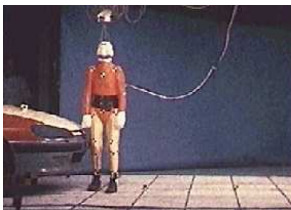
Fig. 2.1 - Image d'un film d'un choc latéral véhicule-piéton (Essai réalisé par le Laboratoire de Biomécanique Appliquée). La jambe droite est la première touchée.
