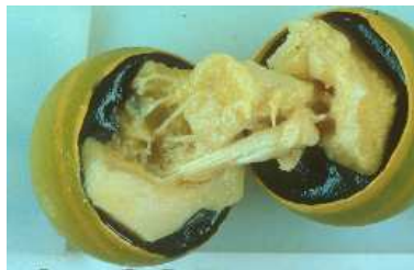
Fig. 5.4 - Une éprouvette préparée avec la résine et les balles (LCA).
