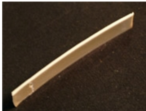
Figure 4. 7 : Profil d'une éprouvette de PPS (1 mm) ayant subi les conditions suivantes : T_{\text{four IR}}=795^{\circ}\text{C} , t_{\text{maintien four IR}} = 11\text{s} , T_{\text{fours côtés}}=50^{\circ}\text{C}
